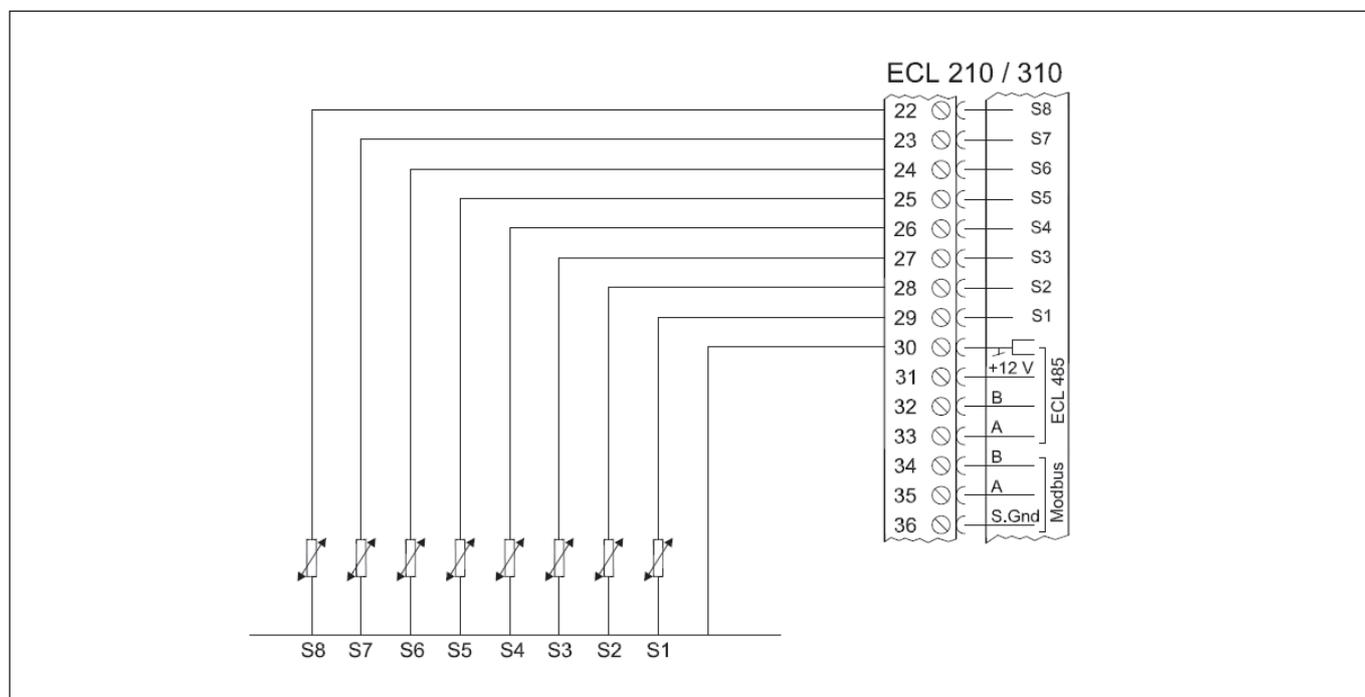
**Электрические соединения, датчики температуры Pt 1000 A375**
