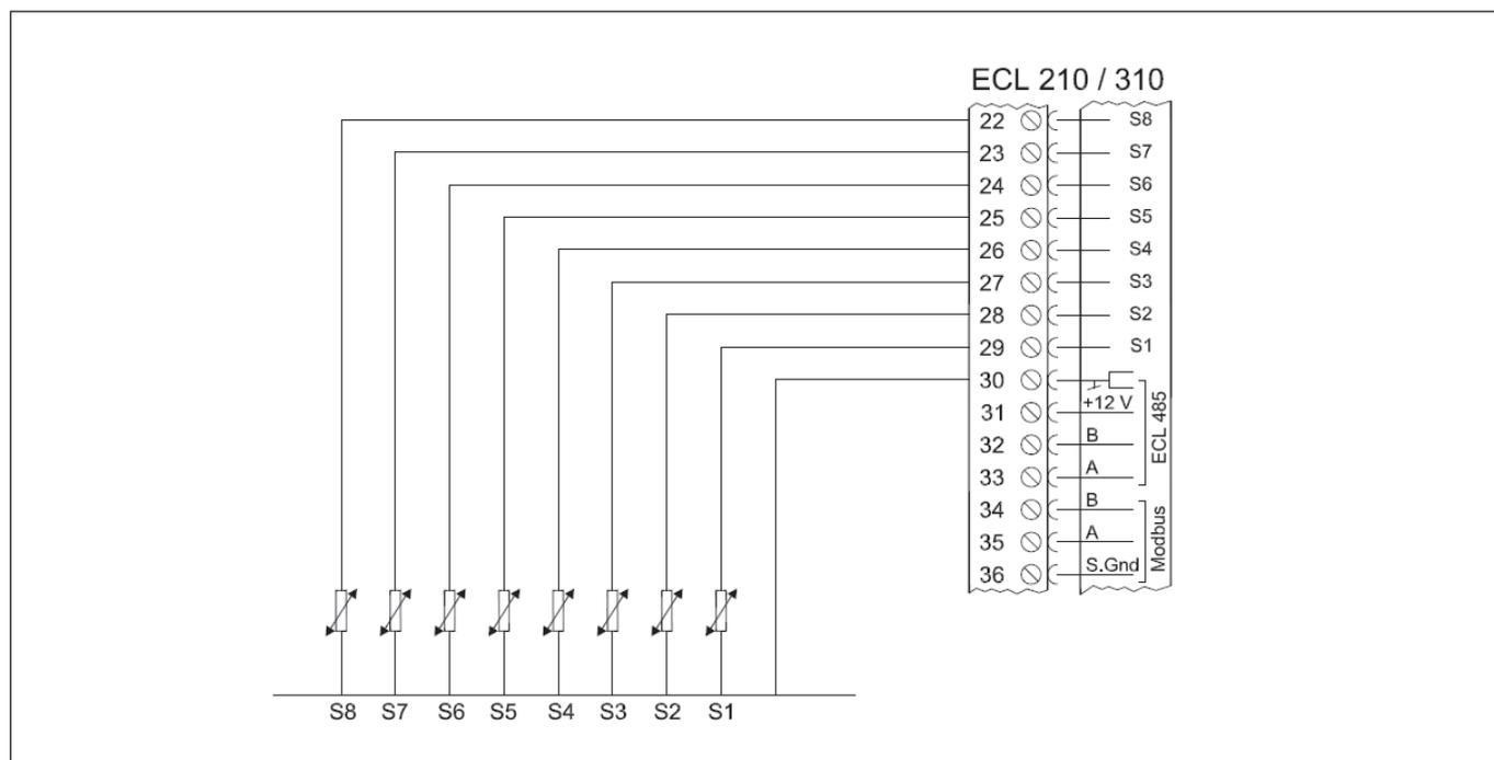
**Электрические соединения дистанционного задатчика требуемой температуры котла (сигнал 0–10 В)**
