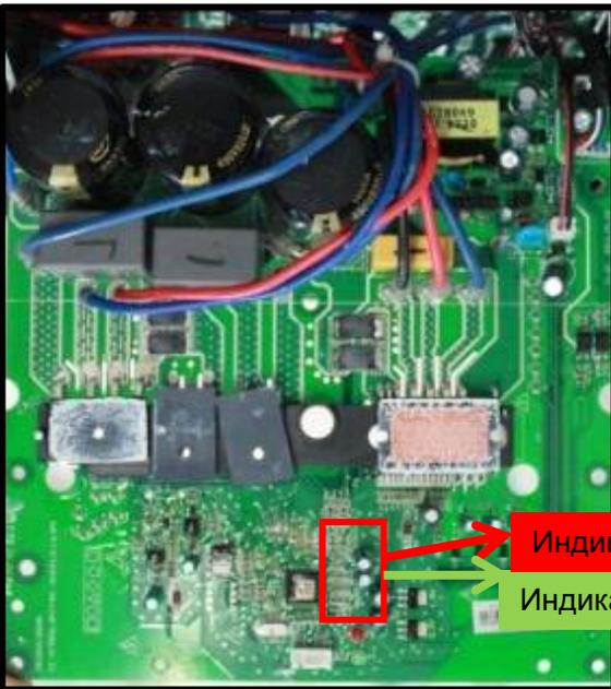
Рис. 2 Блок электропитания или главная плата управления наружного блока (для модели M4OD-28HFN1-Q – три индикатора)
