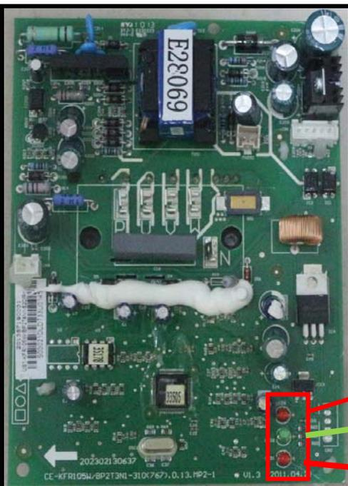
Рис. 2 Блок электропитания или главная плата управления наружного блока (для модели M2OD-18HFN1-Q/M4OA-36HFN1-Q – два индикатора)
