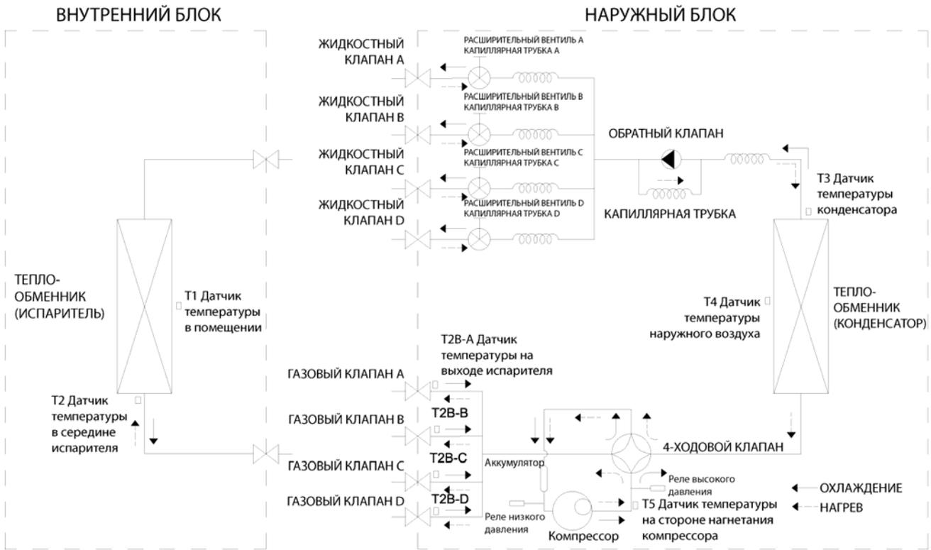
**6.4 Схема холодильного контура M50C-36HFN1-Q**
