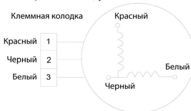
2. Электродвигатель постоянного тока внутреннего блока (микросхема управления расположена в электродвигателе вентилятора)
