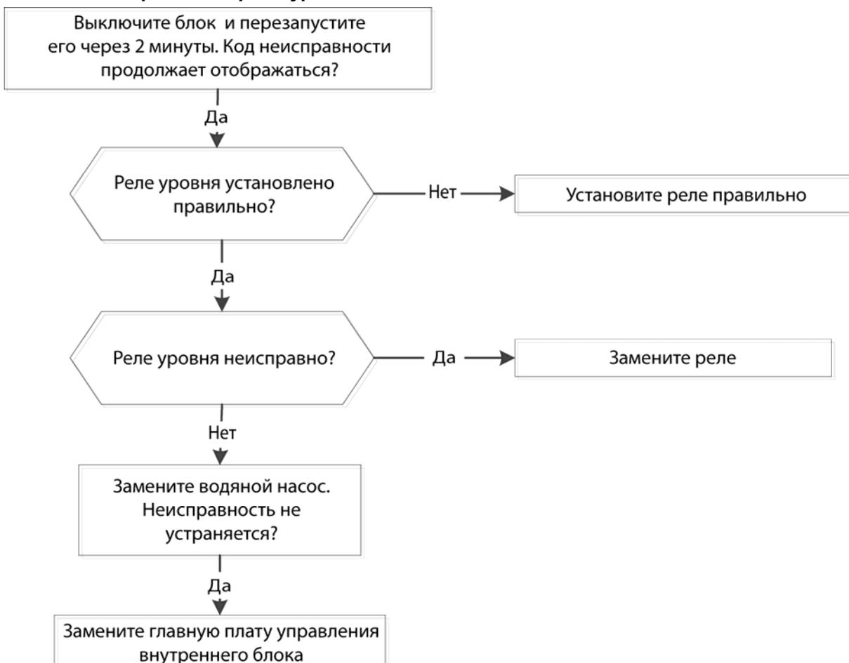
**11.3.2 Наружный блок****11.3.2 1 Неисправность ЭСППЗУ наружного блока (ODU E0)**
