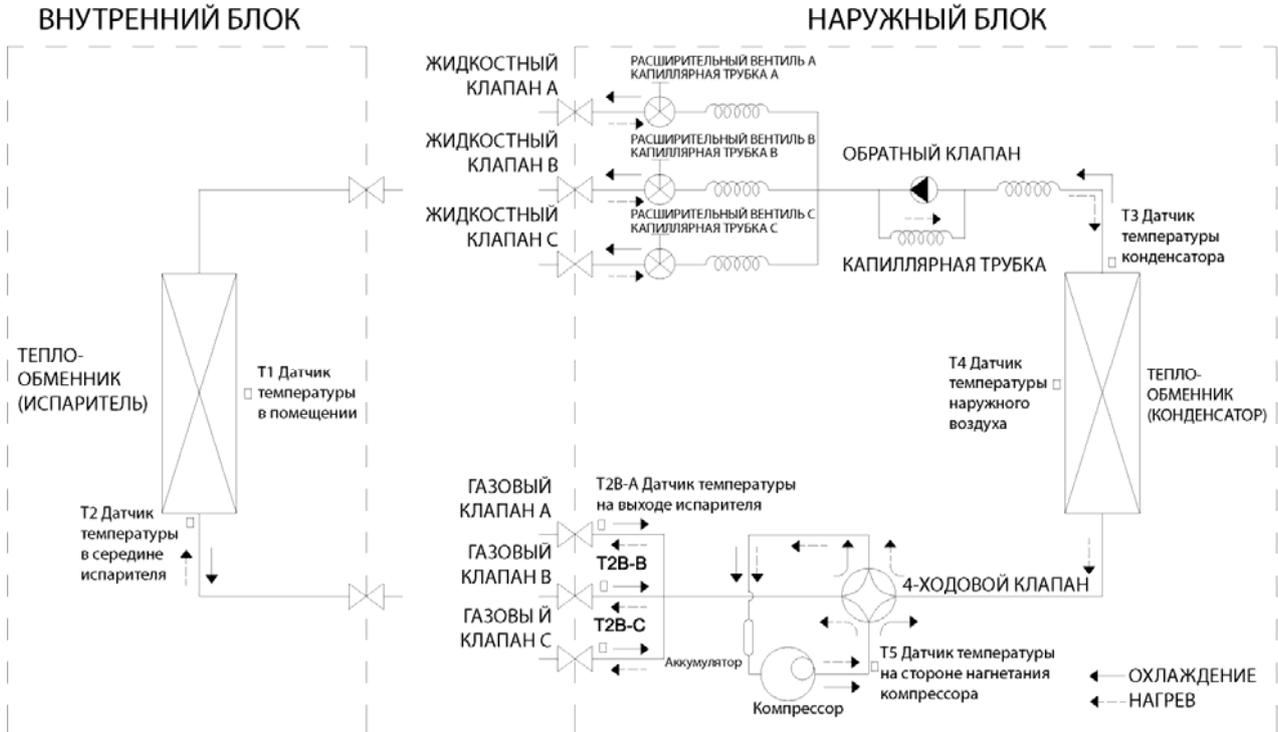
**6.3 Схема холодильного контура инверторной системы с четырьмя внутренними блоками**
